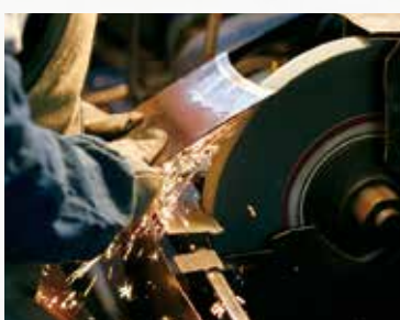
両端の角を厚く、中ほどを薄く加工した刃先は、角が丸くならず、切れ味が何年も続く。
